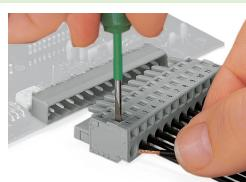
Inserimento di un conduttore mediante cacciavite da 3,5 mm: azionamento di CAGE CLAMP® perpendicolarmente rispetto all'ingresso del conduttore.
