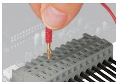
Test: connettore femmina con CAGE CLAMP®
