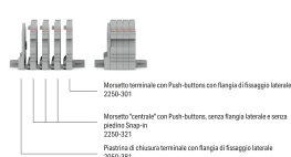
Esempio morsettiere a 4 poli con Push-button con flangia di fissaggio laterale
