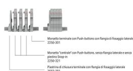
Esempio morsettiere a 5 poli con Push-button con piedini di fissaggio Strip-in
