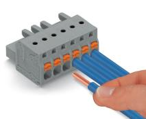
Connessione a innesto dei conduttori rigidi o dei conduttori flessibili con boccola crimpata
