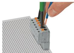
Inserimento dei conduttori flessibili nell'unità Push-in CAGE CLAMP® mediante i pulsanti.
