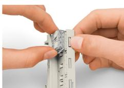
Rimozione di un connettore dal supporto di montaggio.
