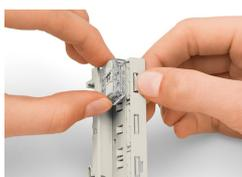
Rimozione di un connettore dal supporto di montaggio.
