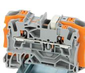
Ponticello di riduzione (2006-499) per collegare i morsetti da 6/4 mm<sup>2</sup> (10/12 AWG) (serie 2206/2204) con i morsetti da 4/2,5/1,5 mm<sup>2</sup> (AWG 12/14/16) (serie 2204/2202/2201).
