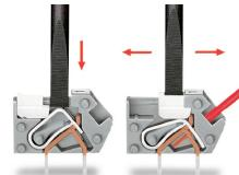
Connessione conduttore: per aprire momentaneamente l'unità di connessione usare un cacciavite, poi inserire un conduttore spelato. Per aprire l'unità di connessione per un periodo prolungato spostare il cursore di bloccaggio verso il foro d'ingresso del conduttore. Poi inserire completamente il conduttore spelato e riportare il cursore di bloccaggio nella sua posizione originale (operazione eseguibile anche con l'unghia del dito).
