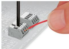
La connessione dei conduttori semi-rigidi negli spazi confinati richiede molta pazienza, a meno che non si usino le nuove morsettiere per circuiti stampati della serie 218. Le unità di terminazione di queste morsettiere possono essere mantenute aperte durante il cablaggio grazie ai cursori di bloccaggio integrati.
