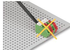
La connessione dei conduttori semi-rigidi negli spazi confinati richiede molta pazienza, a meno che non si usino le nuove morsettiere per circuiti stampati della serie 218. Le unità di terminazione di queste morsettiere possono essere mantenute aperte durante il cablaggio grazie ai cursori di bloccaggio integrati.
