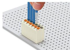
I conduttori rigidi e con boccola crimpata sono connessi premendoli direttamente nell'unità.
