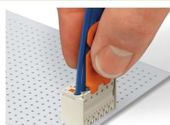
Inserire l'utensile di sgancio fino a che tocca il fondo. Il cuneo apre i fermi di bloccaggio.
