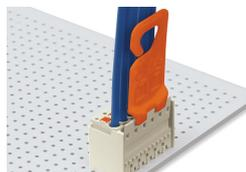
Distacco del connettore femmina mediante l'utensile di sgancio. Inserire l'utensile di sgancio nel nottolino di bloccaggio del connettore maschio.
