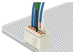
Inserimento di un conduttore flessibile in un connettore femmina accoppiato tramite pulsanti.
