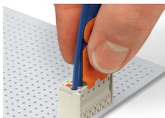
Inserire l'utensile di sgancio fino a che tocca il fondo. Il cuneo apre i fermi di bloccaggio.
