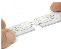
Montaggio: sistemare i circuiti stampati su una superficie piana e connettere i morsetti sulle schede adiacenti tramite collegamento scheda-scheda.
