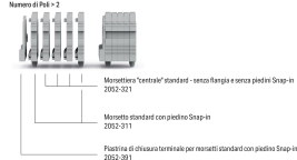
Esempio morsettiere a 5 poli standard con piedini di fissaggio Snap-in
