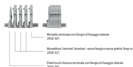
Esempio morsettiere a 4 poli standard con flangia di fissaggio laterale
