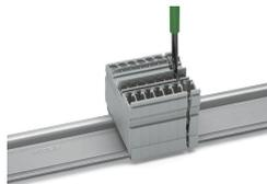
Aprire il gruppo facendo scorrere lateralmente un blocco usando l'utensile (lama di 3,5 x 0,5 mm).
