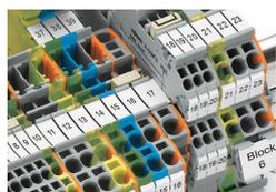
Collegamento a ponte di morsetti del sistema X-COM® S con ponticelli per morsetti TOPJOB® S. Una piastra terminale fornisce la connessione ai morsetti TOPJOB® S. I morsetti delle serie 2020 e 2022 sono combinabili. Le sedi dedicate ai ponticelli seguono lo stesso profilo per entrambe le serie.
