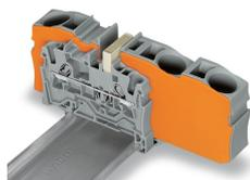
I ponticelli di riduzione collegano i morsetti di differenti dimensioni, senza perdere un punto di connessione per il conduttore. Questo può essere un vantaggio in presenza di conduttori lunghi in cui le cadute di tensione possono essere un problema. Un conduttore con una grande sezione può essere facilmente connesso a conduttori più piccoli con morsetti di ripartizione.
