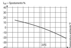
Dati tecnici del fabbricante del fusibile a lama miniaturizzato per automobili
