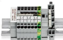
Questo ponticello per punto stella è stato sviluppato in particolare per realizzare una configurazione "punto stella" ed è usato sulle scede per motori dotate di morsetti per guida TOPJOB® S.
