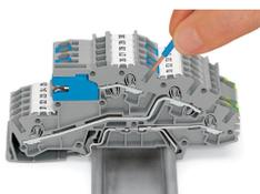
Inserimento di un conduttore mediante terminazione a innesto. I conduttori rigidi con sezione di una dimensione superiore, o fino a due dimensioni inferiori, rispetto alla sezione nominale possono essere inseriti con una semplice pressione, senza bisogno di utensili.
