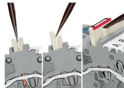
Rimozione di un ponticello a passo: Inserire l'utensile tra i ponticelli a passo e sollevare il ponticello.
