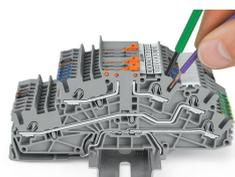
Inserimento di un conduttore mediante utensile di montaggio. La connessione dei conduttori flessibili senza boccola o dei conduttori di sezione ridotta che non possono essere inseriti direttamente, avviene allo stesso modo della connessione CAGE CLAMP®: occorre solo un utensile.
