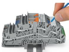
Inserimento di un conduttore mediante terminazione a innesto. I conduttori rigidi con sezione di una dimensione superiore, o fino a due dimensioni inferiori, rispetto alla sezione nominale possono essere inseriti con una semplice pressione, senza bisogno di utensili.
