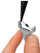
Spine per componente per costruire circuiti personalizzati Montaggio senza saldatura di diodi, resistori, ecc. (la figura mostra un diodo 1N4007)
