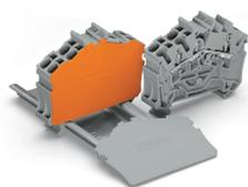
Deve essere inserita una piastra terminale quando si passa da un morsetto per 3 conduttori a un morsetto per 4 conduttori (del tipo angolato) e viceversa.
