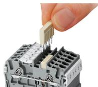
Rimozione di un ponticello a barre a innesto:
