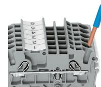
Inserimento di un conduttore mediante terminazione a innesto:
