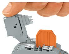
I morsetti con fusibile a due piani con portafusibile pivotante (2002-2611) sono compatibili con i morsetti sezionatori, passanti, di base e per conduttore di terra. Il portafusibile è disponibile anche con un indicatore di fusibile guasto (ad es., 2002-2611/1000-541 per 12-30 V).
