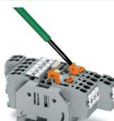
Sedi per la marcatura, una centrale e due laterali, per etichette WMB o strisce di marcatura. Sedi per il ponticello doppie nella stessa posizione come altri morsetti della serie 2002. Collegamento a ponte davanti o dietro la lama sezionatrice, a seconda della direzione dell'alimentazione.
