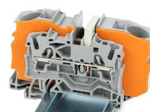
I ponticelli di riduzione collegano i morsetti di differenti dimensioni, senza perdere un punto di connessione per il conduttore. Questo può essere un vantaggio in presenza di conduttori lunghi in cui le cadute di tensione possono essere un problema. Un conduttore con una grande sezione può essere facilmente connesso a conduttori più piccoli con morsetti di ripartizione.
