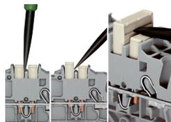
Rimozione di un ponticello a barre a innesto:
