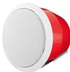
Diffusore rotondo da incasso a soffitto, **IP21**, fornito con fondello antifiamma in acciaio completo di kit tagliafuoco. **Certificato EN60849 EN54-24 nr di certificazione 0068-CPR-035/2016**. Struttura in acciaio con griglia di protezione. Morsettiere di collegamento in materiale ceramico per i conduttori antifiamma, vite di messa a terra, cablaggio interno realizzato con conduttori antifiamma.
