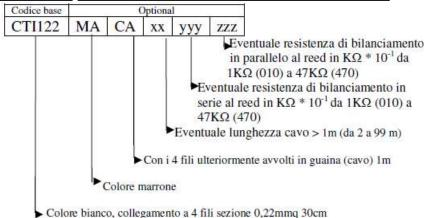
Le caratteristiche riportate in questa nota tecnica sono di esclusiva proprietà di Vimo elettronica snc Le caratteristiche del prodotto possono variare in funzione delle condizioni ambientali.
