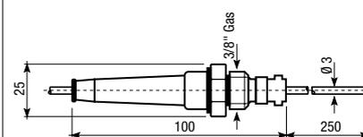
Si raccomanda l'impiego di conduttori isolati al silicone da 1,5 mm<sup>2</sup> per il collegamento degli elettrodi sotto descritti al relè di controllo livello.
