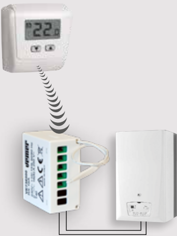
Esempio di collegamento con un attuatore remoto a 1 canale. L'attuatore remoto deve essere alimentato solo da rete elettrica.
