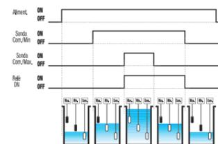
Electrodo per il controllo del MAX
