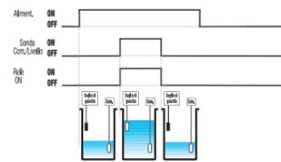
Electrodo per il controllo del LIVELLO
