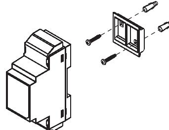
In caso di fissaggio a parete DEVE essere installata la copertura di protezione dei morsetti.
