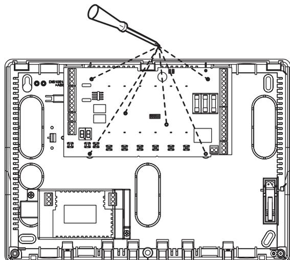
Per ricollocare la scheda madre in centrale posizionarla nuovamente sui suoi supporti e riavvitare le viti di fissaggio, senza sforzare per non danneggiare il circuito stampato.
