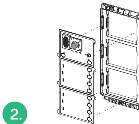
Si prosegue con l'inserimento ad incastro dei vari moduli sul telaio e con il collegamento tra i moduli, mediante i cavetti flat a corredo.
