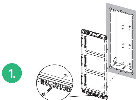
Con la vite fornita con il prodotto, si fissano la parte inferiore e il telaio portamoduli, sulla scatola ad incasso presente nel muro.
