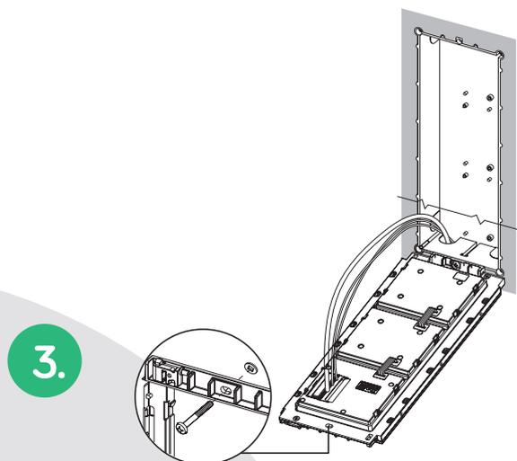
Si collegano i due fili della montante 2Voice o IPerCom e quelli della serratura elettrica, fissando il tutto con l'altra vite sulla parte superiore del telaio.
