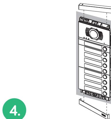
Si completa l'installazione con l'inserimento ad incastro dei frontali estetici e delle testate superiori e inferiori.
