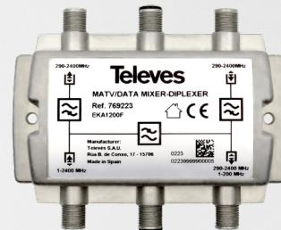
Questo elemento passivo può essere installato in qualsiasi punto dell'impianto coassiale, per separare i segnali televisivi terrestri e satellitari (290...2400 MHz) dal segnale dati (1...200 MHz), e per poterli gestire in modo indipendente (principalmente per l'amplificazione).
