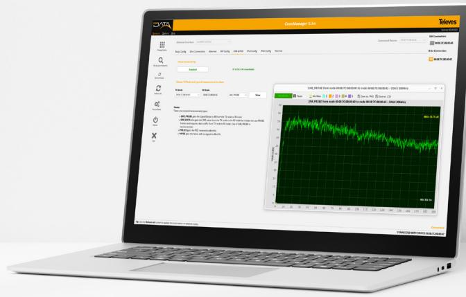
Monitoraggio ed evoluzione nel tempo dei parametri della rete RF: rapporto segnale/rumore (SNR), densità spettrale di potenza (PSD), rumore di fondo, ecc.
