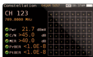
SCHERMATA COSTELLAZIONE ANALIZA IN DETTAGLIO IL SEGNALE QAM
