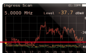
ANALISI DEL CANALE DI RITORNO MASSIMO, VALORE MEDIO E PICCO
