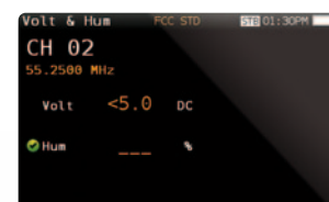
VOLTMETRO E HUM TENSIONE E RUMORE DI ALIMENTAZIONE PRESENTE SULLE RETE SUL CAVO
