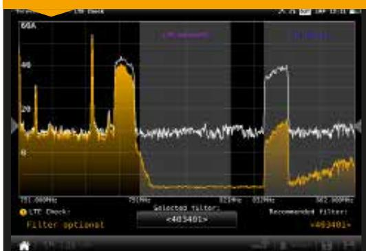
Analizza l'interferenza del segnale LTE sui canali DTT, rilevando la necessità di incorporare o meno i filtri. Permette anche di simulare lo spettro dopo aver incorporato un filtro LTE che lo strumento stesso consiglia. Viene presentato un elenco di filtri in modo che l'utente possa scegliere quello che meglio si adatta alla sua installazione.
