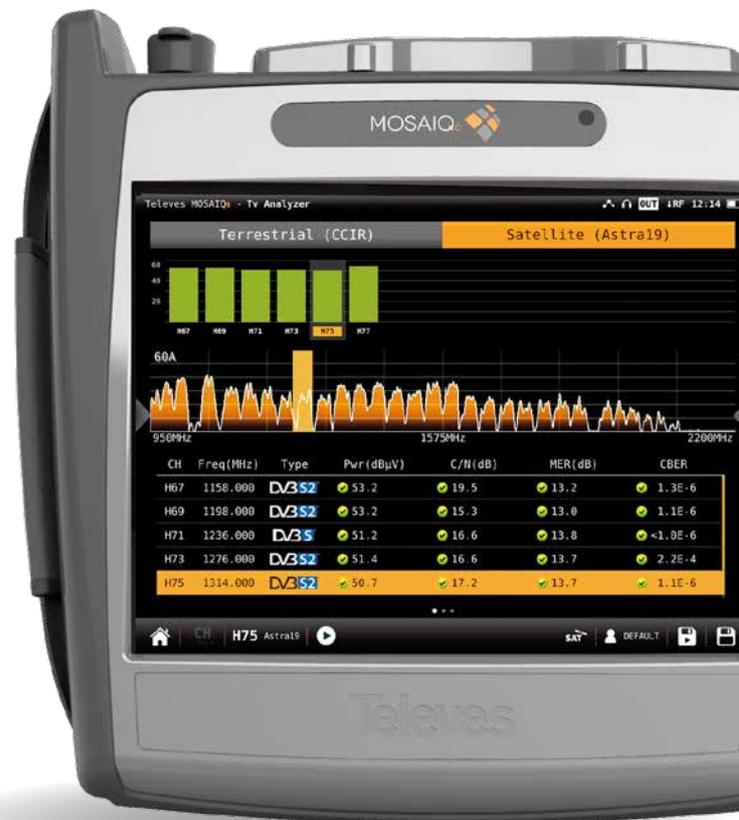
Nella stessa schermata puoi misurare tutti i canali dello spettro (frequenza, potenza, C/N) con parametri aggiuntivi come TILT o attenuazione.
