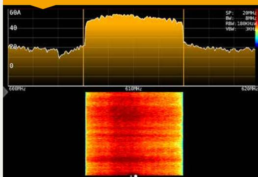
Rappresentazione grafica del segnale in tempo e frequenza. I livelli del segnale vengono convertiti in colori e sono rappresentati sull'asse del tempo (vedi figura). Uno strumento ottimale per analizzare interferenze o dissolvenze di segnale di breve durata che con il solo spettro sarebbero difficili da rilevare.
