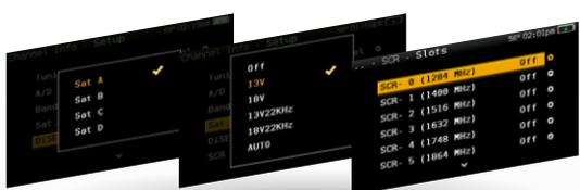
Configurato per impostare automaticamente i parametri necessari ed eggianciare il suo segnale satellitare; inoltre potremo alimentare amplificatori da palo e pilotare comandi DiSEqC e SCR/dCSS.
