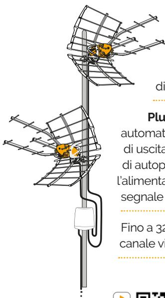
Dispositivo **"All-in-one"**: combina le funzioni dei diversi elementi che compongono un impianto: come filtri, miscelatori e amplificatori, fornendo sul cavo in uscita una distribuzione completa del segnale.
