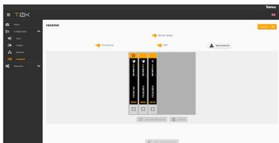
Configura uno dei moduli come master dell'intera centrale. Ogni modulo può essere selezionato come master. Una volta attivata la modalità master, l'unità cerca altre unità collegate alla rete (ETH2).
