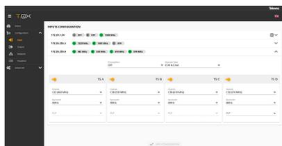
L'unità ha quattro demodulatori (TS A, TS B, TS C, TS D) collegati a un singolo ingresso di segnale. L'unità funziona sempre in modalità loop.
