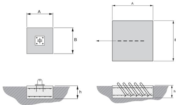
Disegno delle fondamenta della base del traliccio
